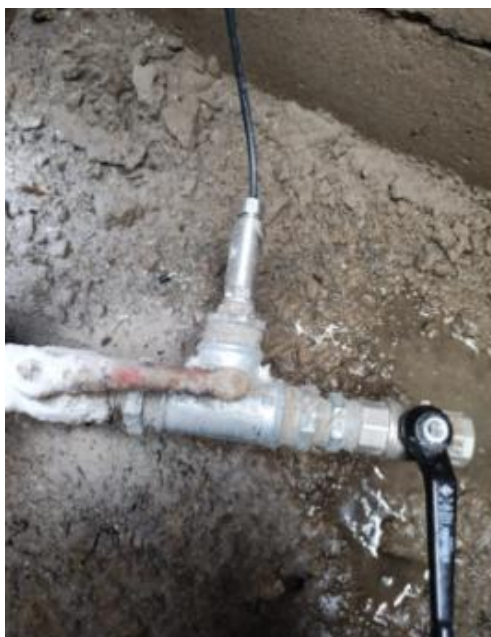
Misuratore di pressione ID: ALT P10 TIPO KELLER 222625,1245 11/24
