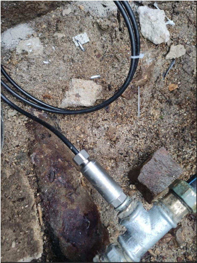
TRASDUTTORE DI PRESSIONE Keller RETE VILALAGO PAESE ID: VIL_P05
