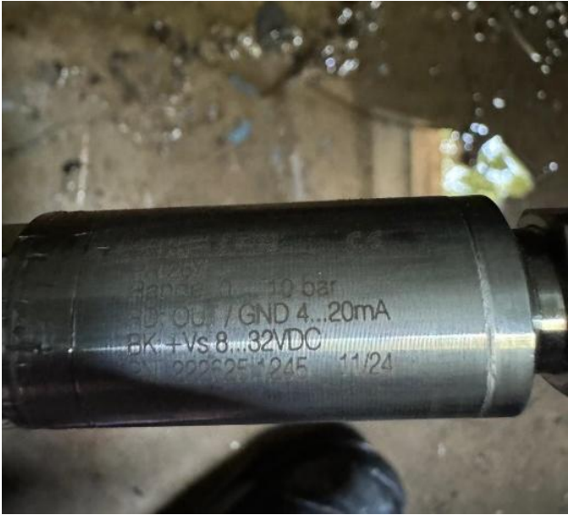
Misuratore di pressione ATELETA SERBATOIO CARCERI ALTE ID:ATL_P01 TIPO KELLER PN 222625,1245 11/24
