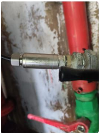
Misuratore di pressione ATELETA SERBATOIO PITTASI ,ID:ATL_P02 CODICE 222625.1245. 11/24
