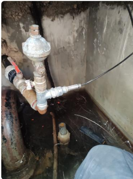
Misuratore di pressione COCULLO POZZETTO. ID: COC_P04 TIPO KELLER PN:222625 1245 11/24
