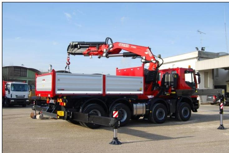
Figura 3-6: Autocarro con gru per la movimentazione dei carichi
