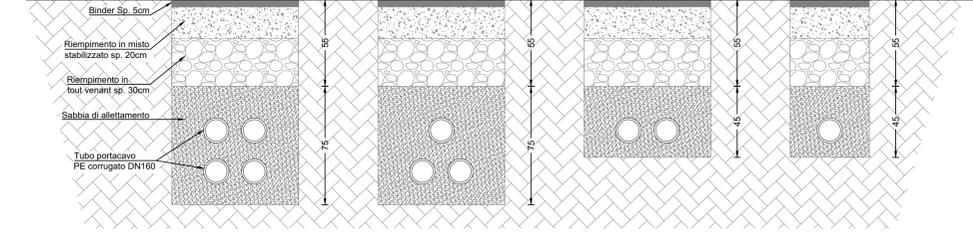
**SEZIONI TIPO CAVIDOTTI DISTRIBUZIONE BASSA TENSIONE E TELECONTROLLO**
