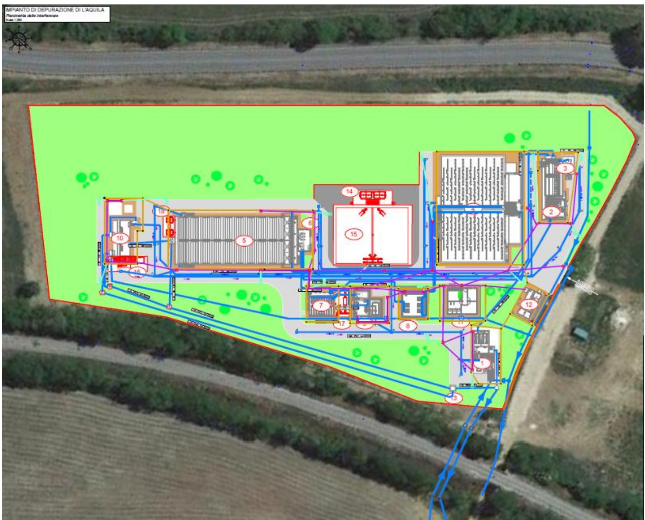
Figura 4-1 - Interferenze con le condotte esistenti
