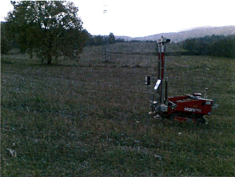
Foto n°1 – Postazione prova penetrometrica P1.
