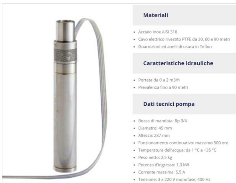
Fig.6- Elettropompa modello GROUND FOS 3" con relative caratteristiche tecniche.
